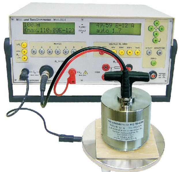
Messung des Oberflächenwiderstandes mit der AE 30 und geerdeter Grundplatte GP 14 (optional) am Milli-TO 3
