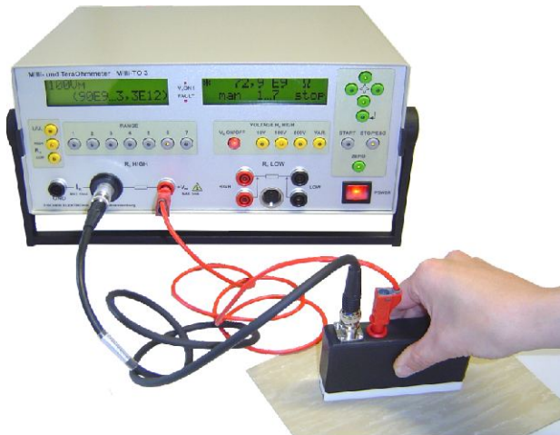
Handgeführte Messung HOW 1 mit Milli-TO 3 (optional)
