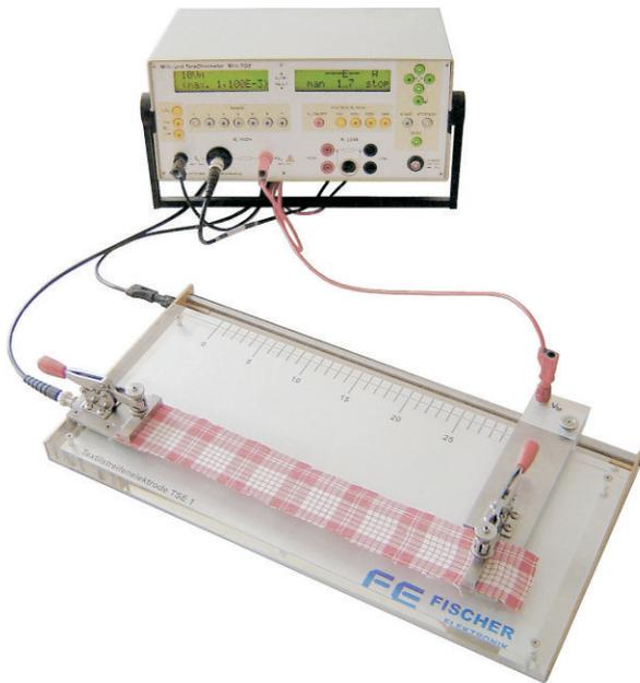
Die Textilstreifenelektrode TSE 1 eignet sich zur Messung des elektrischen Widerstandes an Streifen aus textilen Flächengebilden, die zur Verbesserung der Ableitfähigkeit von elektrostatischen Ladungen Beimischungen aus Materialien enthalten, deren Widerstand wesentlich geringer ist als der des textilen Materials.
