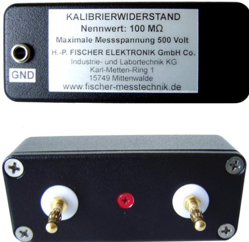
Die Hochohm-Kalibrierwiderstände eignen sich zur schnellen Überprüfung und Kalibrierung von Widerstandsmessgeräten. Ein stabiles Metallgehäuse bietet Schutz vor äußeren Einflüssen. Die Anordnung der 4 mm Anschlussstecker erlaubt den direkten Anschluss der Kalibrierwiderstände an unsere Messgeräte-serie Milli-TO.
