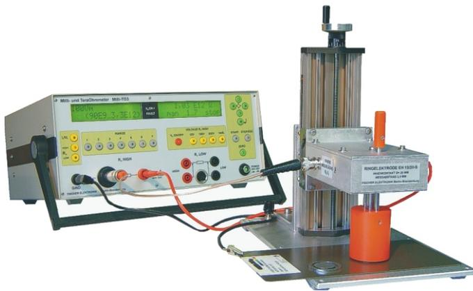
Die Messelektroden EH15/10 bzw. EH15/20 wurden speziell für die Volumen- oder Oberflächenwiderstandsmessung an kleinen plattenförmigen Proben entwickelt.
