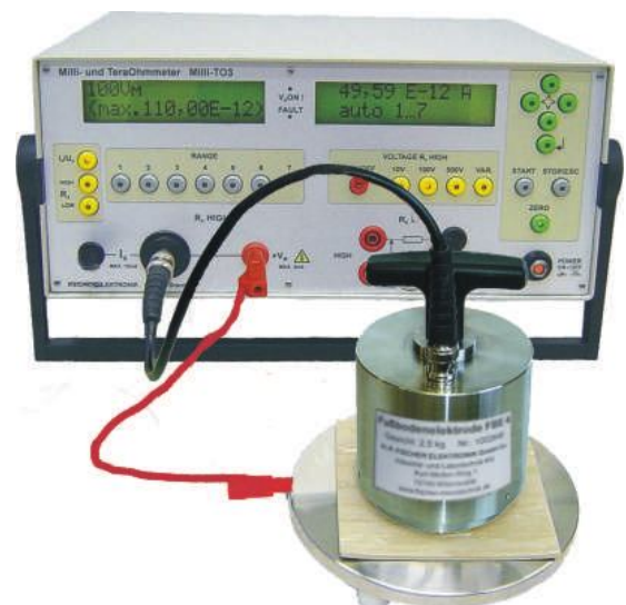
Messung Durchgangswiderstand mit FBE 4 und Erdungsplatte GP 14 * und Milli-TO 3 *
