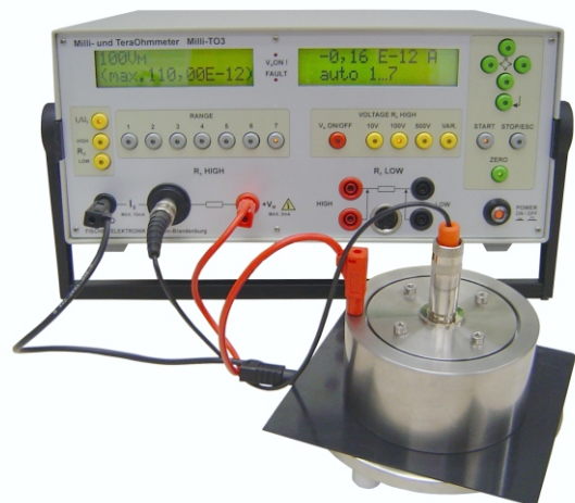
Messung des Oberflächenwiderstand mit der Grundplatte GP14 (optional) und dem Milli-TO 3 (optional)
