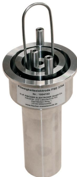
Die Flüssigkeitselektrode FSE 3704 eignet sich für die Messung des spezifischen Widerstandes isolierender Flüssigkeiten nach DIN EN 60247 und GOST 6581-75. Die Elektrode entspricht dem in diesen Normen dargestellten Aufbau.
