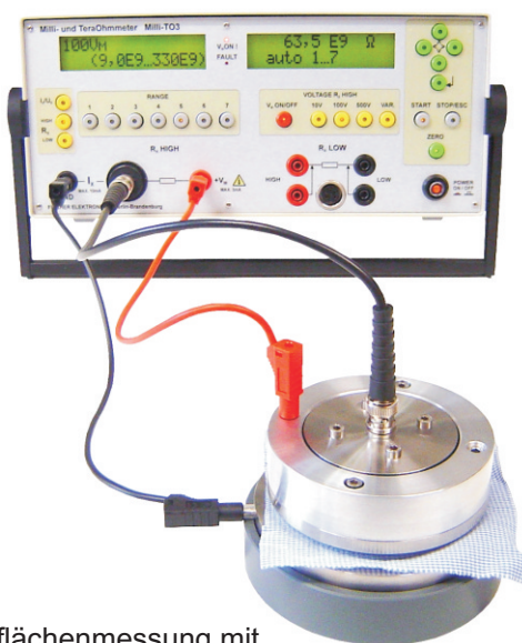
Oberflächenmessung mit geerdeter Grundplatte
